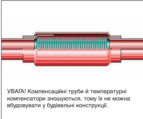
Мал. 28. Труба з трубним температурним компенсатором (з металевим сільфоном)
