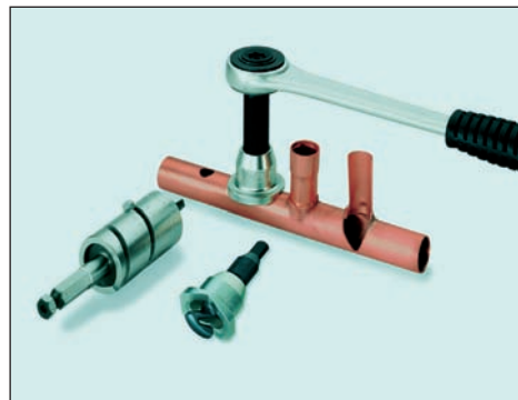
Мал. 22. Спеціальний свердлики, пристрій для виготовлення крайки та гайковий ключ з тріскачкою
