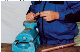
в) упевнитися, що кільце добре допасоване. Не використовувати змазок та мастил;
