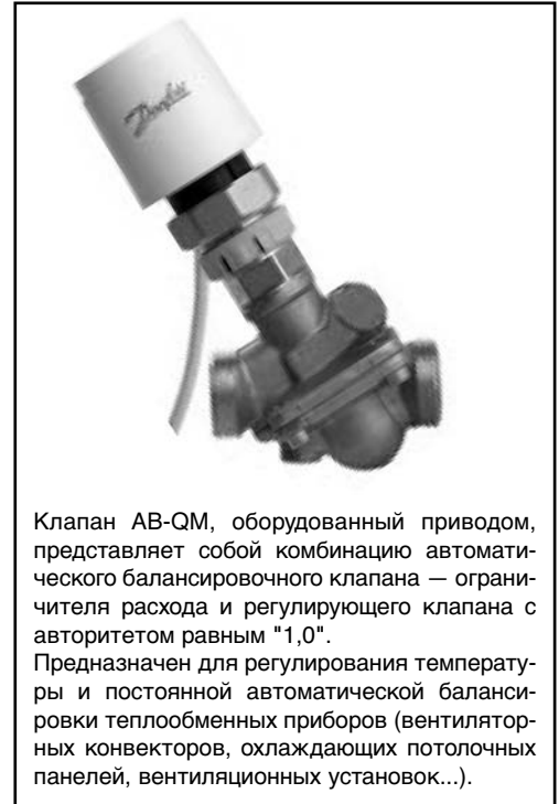
АВ-QM – автоматический балансировочный клапан – ограничитель расхода. Предназначен для автоматического ограничения установленного расхода в теплообменных приборах (вентиляторных конвекторах, охлаждающих потолочных панелях, вентиляционных установках) или ответвлениях. Рекомендуется применять в системах с постоянным расходом.
