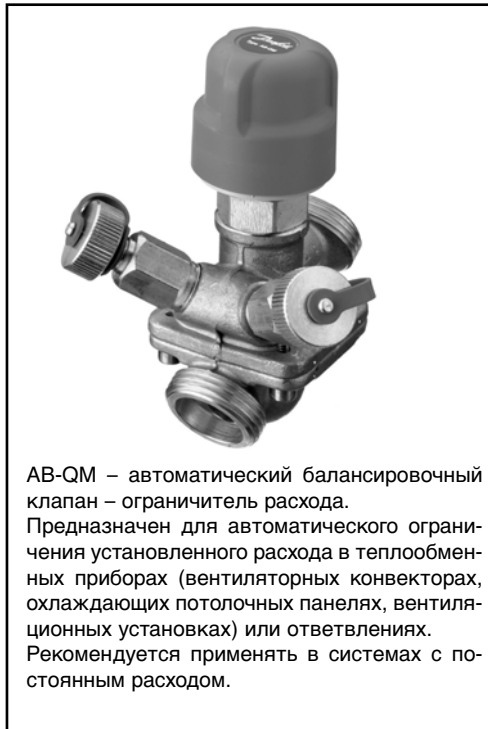
Клапан АВ-QM, оборудованный приводом, представляет собой комбинацию автоматического балансировочного клапана – ограничителя расхода и регулирующего клапана с авторитетом равным "1,0". Предназначен для регулирования температуры и постоянной автоматической балансировки теплообменных приборов (вентиляторных конвекторов, охлаждающих потолочных панелей, вентиляционных установок...).
